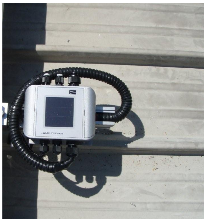
Рис. 1. Датчик инсоляции Sunny Sensorbox от компании SMA Solar Technology AG
